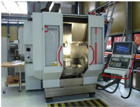
Figura 4.23: Centro de usinagem Hermle C30U Dynamic.
